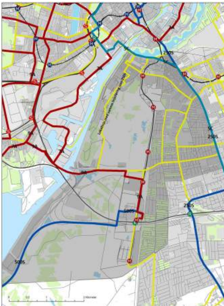
Figur 5: Forslag til strategisk busnet i og omkring Amager Vest-bydel. Forslag til strækninger betjent med A-bus er markeret med mørkerød, forslag til strækninger betjent med S-bus markeret med mørkeblå. Linje 5C (nuværende linje 5A) er markeret med +Way-farven turkisblå. Strækninger, der foreslås betjent med lokale buslinjer, er markeret med gul. Linjenumre skal betragtes som arbejdstitler.
