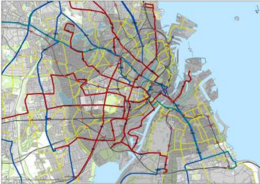
Figur 3: Forslag til strategisk busnet i Københavns Kommune i 2019. Forslag til A-linjer er markeret med mørkerødt (linje 5C dog med +Way-blå), forslag til S-linjer er markeret med mørkeblå. Strækninger og korridorer der foreslås betjent med lokale buslinjer er markeret med gult. Linjenumre skal betragtes som arbejdstitler.
